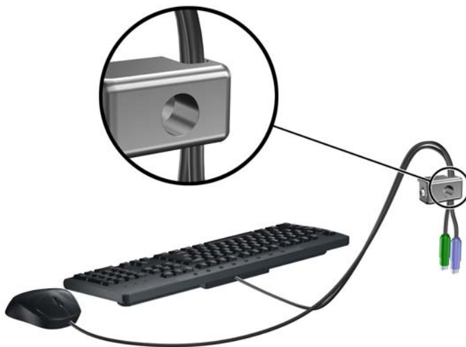
Рисунок 2-45 Протаскивание кабелей клавиатуры и мыши через отверстие блокировочного устройства.
