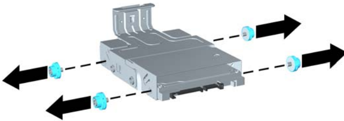
Рисунок 5-17 Удаление направляющих винтов
