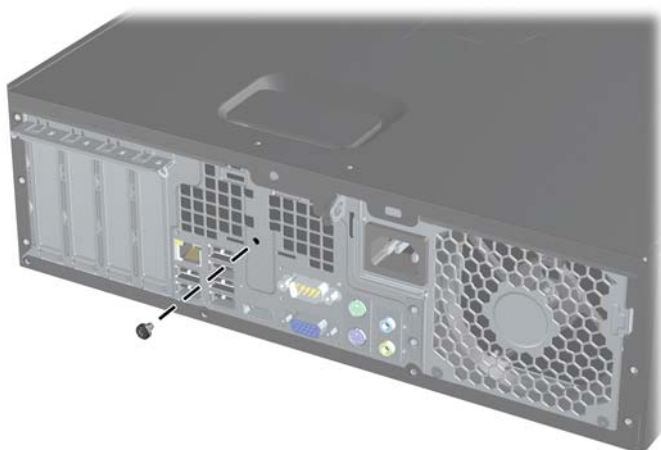
Рисунок В-3 Извлечение стопорных винтов для закрепления крышки с модели с уменьшенным корпусом
