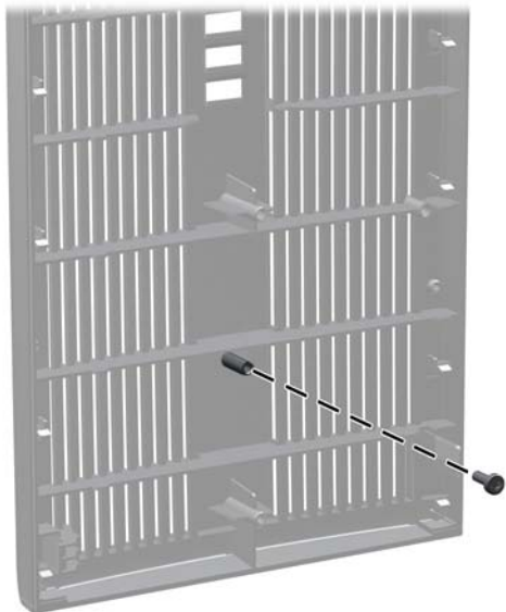
Рисунок 2-49 Поиск блокировочного винта передней панели
