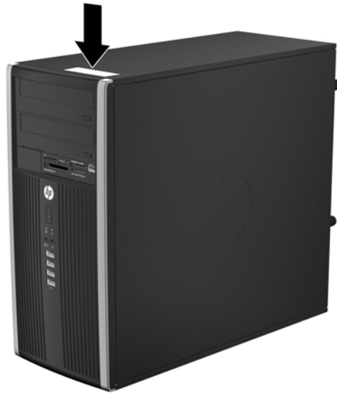
Рисунок 1-16 Расположение серийного номера и идентификационного номера продукта на модели с уменьшенным корпусом
