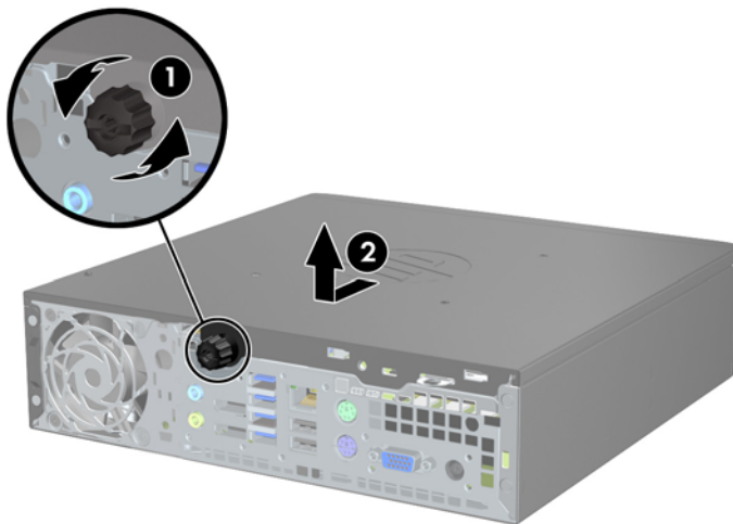
Рисунок 5-2 Снятие защитной панели компьютера
