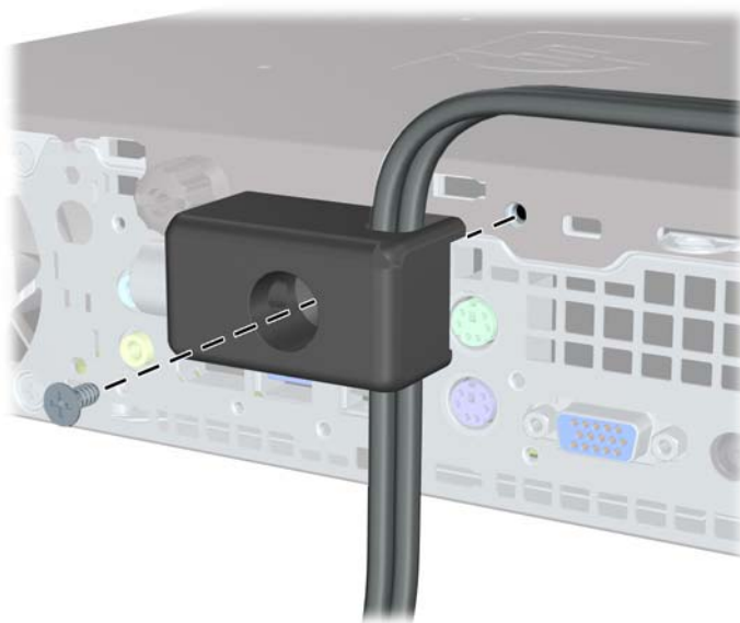
Рисунок 5-32 Закрепление замка на корпусе
