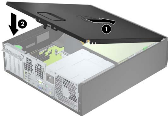
Рисунок 4-2 Установка защитной панели компьютера
