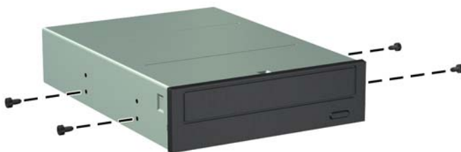
Рисунок 3-20 Установка оптического дисковода
