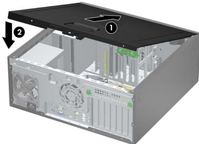
Рисунок 2-2 Установка защитной панели компьютера
