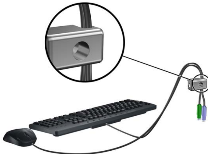
Рисунок 4-46 Установка кабелей клавиатуры и мыши в замок
