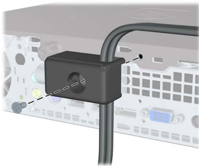
7. Вставьте палец, закрепленный на тросике, в замок (1) и вдавите кнопку (2), чтобы закрыть замок. Для открывания замка используйте прилагаемый ключ.
