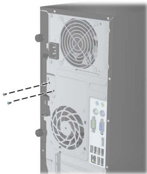
**Рисунок В-3** Извлечение стопорных винтов для закрепления крышки с модели с уменьшенным корпусом
