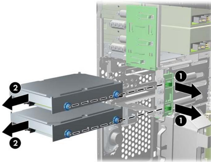
8. Вывинтите четыре винта (по два с каждой стороны), удерживающие заменяемое устройство. Они понадобятся для установки нового устройства.
