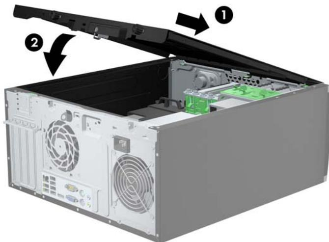
2. Убедитесь, что панель полностью встала на место и заверните два винта (1), фиксирующую ее к корпусу компьютера.
