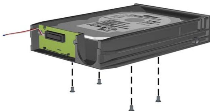
5. Сдвиньте жесткий диск назад, чтобы отсоединить его от контейнера, а затем поднимите его, чтобы извлечь из контейнера.
