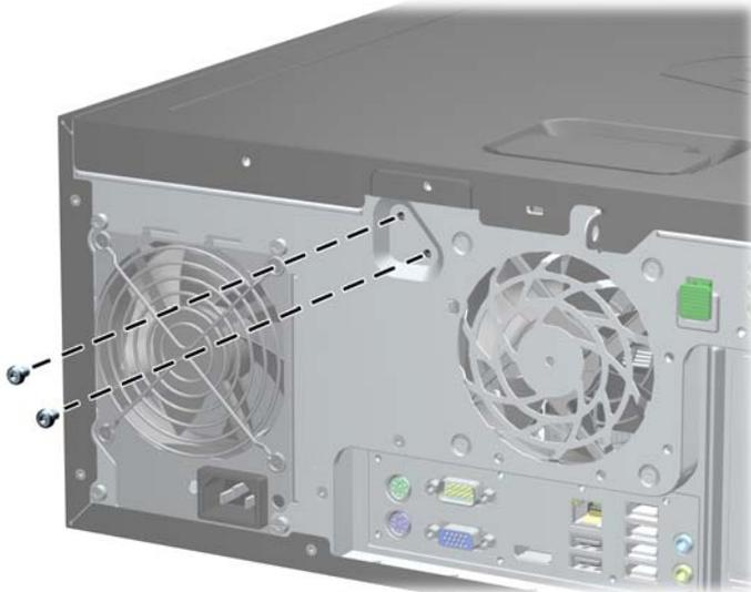
**Рисунок В-2** Извлечение стопорных винтов для закрепления крышки с модели вертикальным корпусом
