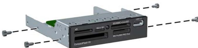
4. Поместите направляющие винты в J-образных пазах отсека. Затем продвиньте дисковод вперед к передней панели компьютера, пока он не зафиксируется на своем месте.
