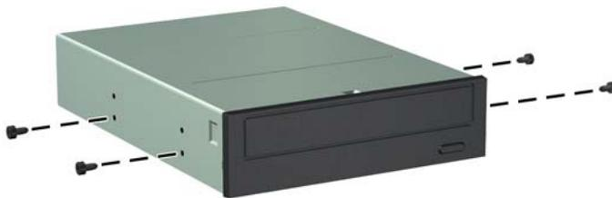
8. Плавно вдвигайте устройство в отсек, следя за тем, чтобы направляющие винты совпали с направляющими отверстиями, пока оно не встанет на место.
