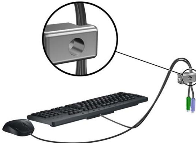
6. Закрепите замок на корпусе с помощью прилагаемого винта с накатной головкой.
