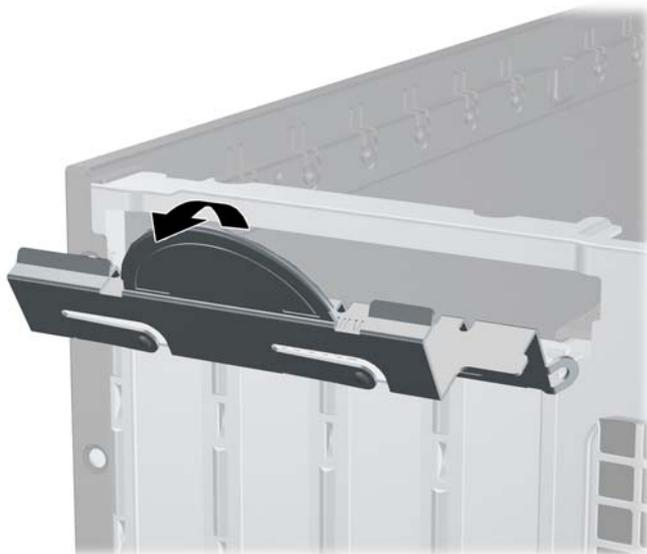
9. Перед установкой платы расширения снимите крышку гнезда расширения или уже установленную плату расширения.
