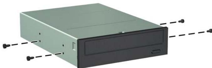
9. Поместите направляющие винты в J-образных пазах отсека. Затем продвиньте дисковод вперед к передней панели компьютера, пока он не зафиксируется на своем месте.
