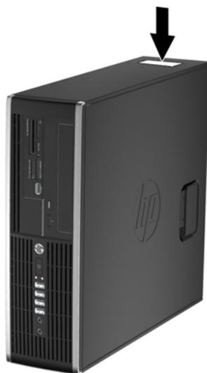
**Рисунок 1-17** Ultra-Slim Desktop (USDТ) Расположение серийного номера и идентификационного номера продукта на модели со сверхплоским корпусом
