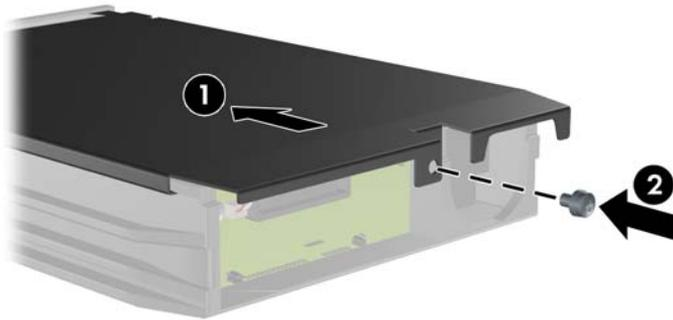
10. Задвиньте контейнер жесткого диска в бокс, находящийся в компьютере, и заблокируйте его с помощью прилагаемого ключа.
