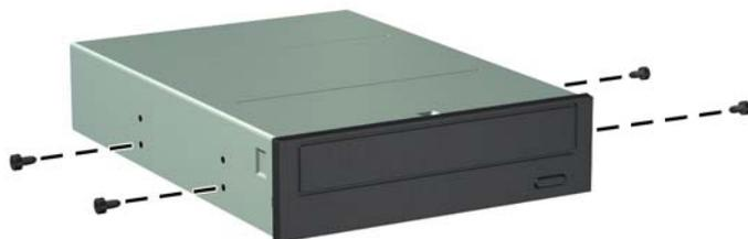
**Рисунок 4-23** Установка направляющих винтов оптического дисководов (2 из 2)
