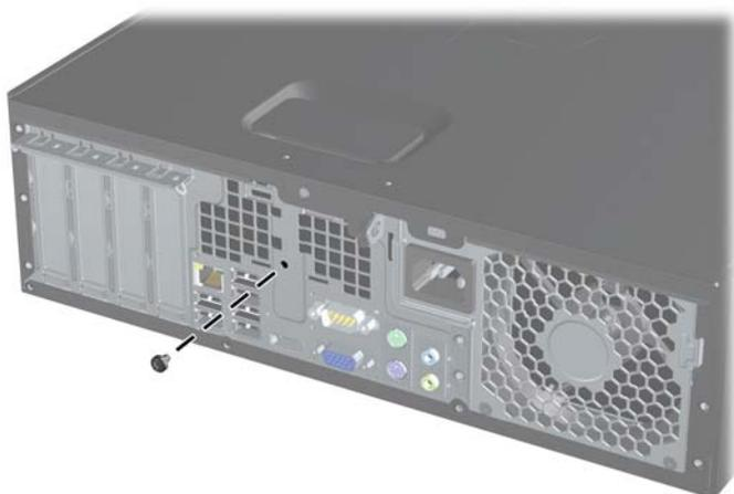
Теперь можно снять защитную панель с компьютера.
